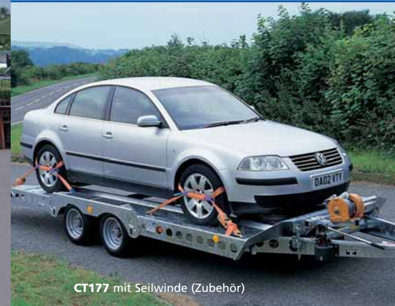
CT177 in abgesenkter Position mit Seilwinde (Zubehör)
